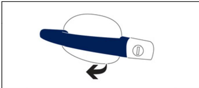
☞ Après déverrouillage total du véhicule à la télécommande ou à la clé, saisissez la poignée de porte, puis tirez-la. La vitre descend automatiquement de quelques millimètres pour permettre l'ouverture de la porte.
