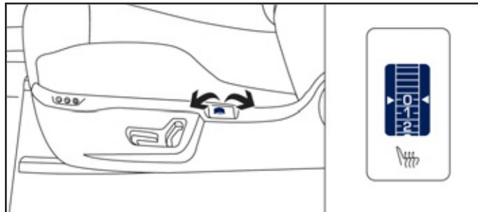
Moteur tournant, les sièges avant peuvent être chauffés séparément.
