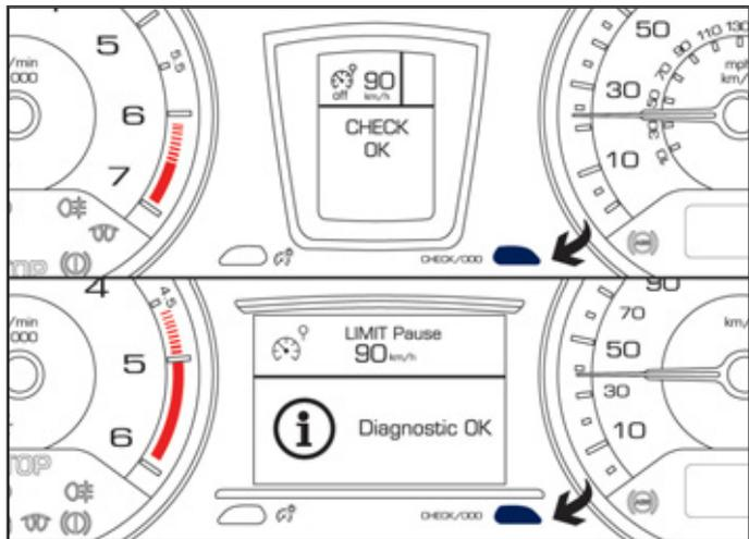
☞ Moteur tournant, pour lancer un check manuel, effectuez un appui bref sur le bouton **«CHECK/000»** du combiné.
