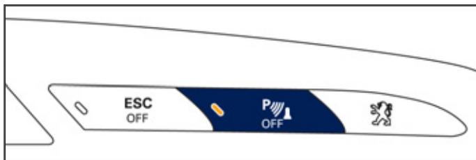
La neutralisation de la fonction s'effectue par un appui sur ce bouton. Le voyant du bouton s'allume.
