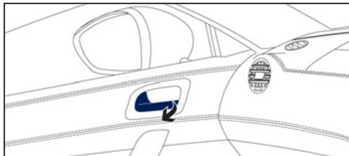
☞ Tirez la commande de porte pour ouvrir la porte ; celle-ci déverrouille tout le véhicule.
