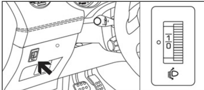
Pour ne pas gêner les autres usagers de la route, les projecteurs à lampes halogènes doivent être réglés en hauteur, en fonction de la charge du véhicule.
