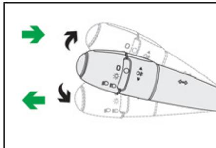
Relevez ou baissez la commande d'éclairage en passant le point de résistance ; les indicateurs de direction correspondants clignoteront jusqu'au retrait de la position.
