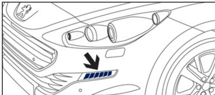
Pour le remplacement de ce type de lampe à diodes électroluminescentes, consultez le réseau PEUGEOT ou un atelier qualifié.
