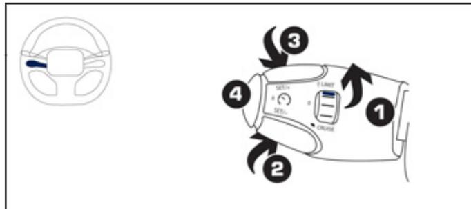
Les fonctionnalités de ce système sont regroupées sur la commande sous-volant.
