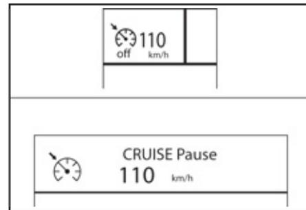
Le mode régulateur ou limiteur de vitesse apparaît dans le combiné quand celui-ci est sélectionné.
