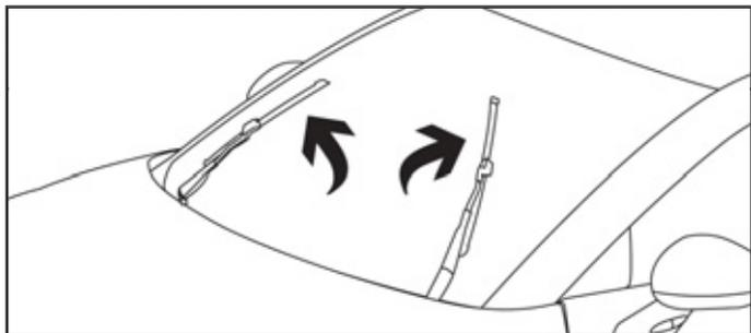
Cette position permet de dégager les balais de l'essuie-vitre avant. Elle permet de nettoyer les lames ou de procéder au remplacement des balais. Elle peut également être utile, par temps hivernal, pour dégager les lames du pare-brise.
