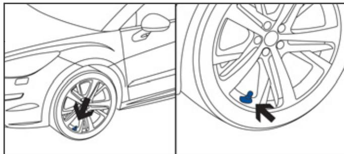
Des capteurs, montés dans chaque valve, déclenchent une alerte en cas de dysfonctionnement (vitesse supérieure à 20 km/h).
