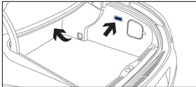
Votre véhicule est équipé de deux éclairages de coffre ; un premier dans la garniture latérale droite du coffre et un second au centre sous la tablette arrière.
