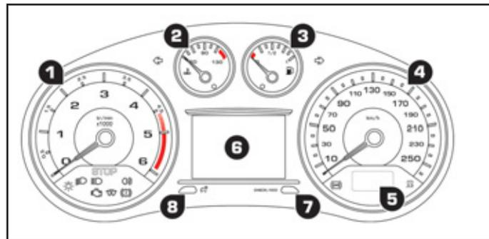
Panneau, regroupant les cadrans et les témoins d'indication de fonctionnement du véhicule, équipé d'un rétro-éclairage permanent.
