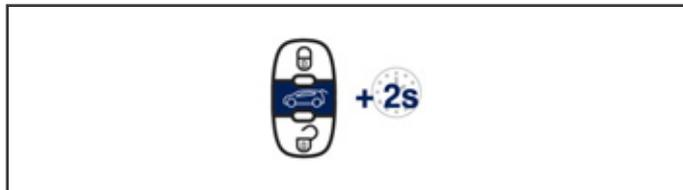
1. Déverrouillage et entrebâillement du volet de coffre.
